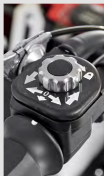
Geschwindigkeitsregulierung über einfach zu bedienenden Drehgriff
