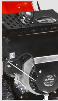
Motorabdeckung zum Schutz des Motors im Wintereinsatz (optional)
